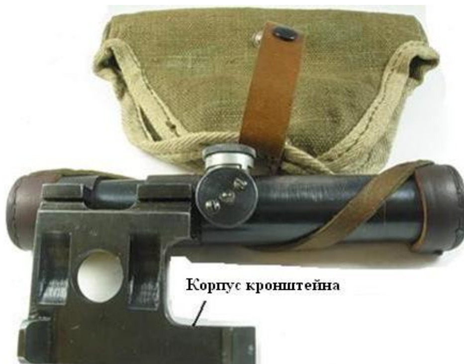
Рис. 6. Внешний вид прицела ПУ с кронштейном бокового крепления, чехлом и пылезащитными колпачками
