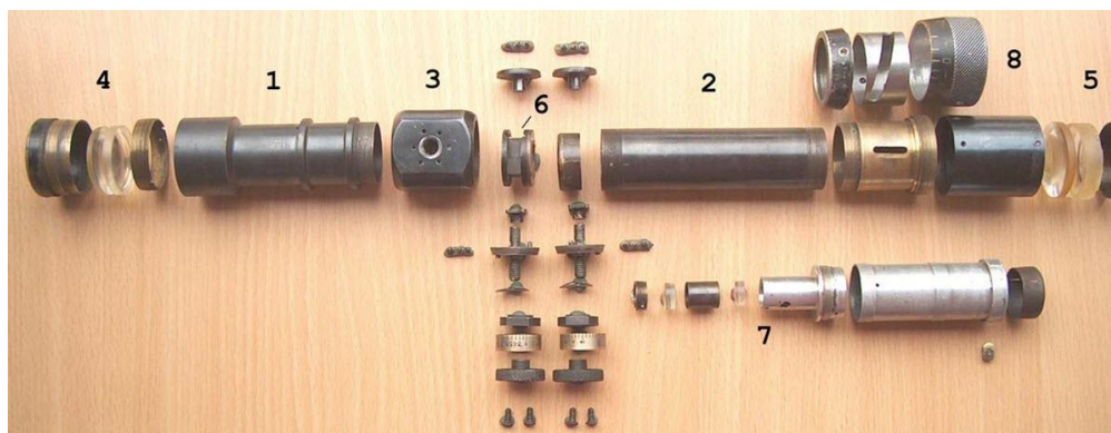
Рис. 2. Элементный состав прицела ПЕ: 1 – трубка объектива; 2 – промежуточная трубка; 3 – корпус; 4 – объектив; 5 – окуляр; 6 – механизмы горизонтальных и вертикальных поправок; 7 – оборачивающая система; 8 – механизм диоптрийной установки окуляра
