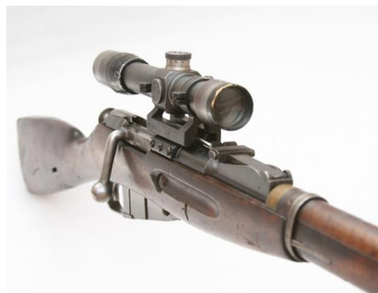
Рис. 3. Снайперская винтовка СВМ-91/30 с оптическим прицелом ПЕ
