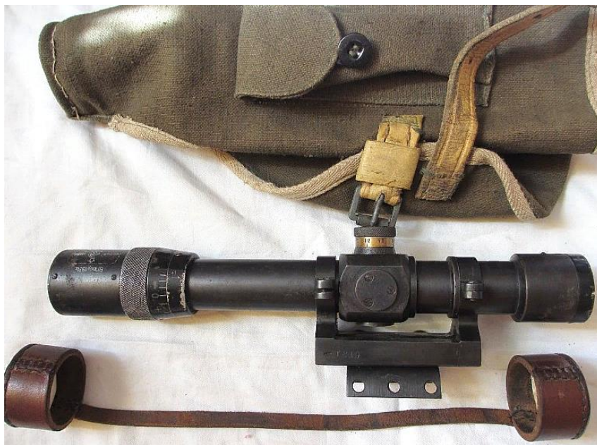
Рис.1. Внешний вид прицела ПЕ с кронштейном вертикального крепления, чехлом и пылезащитными колпачками
