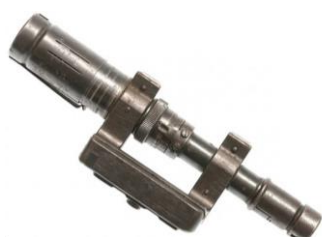
Рис. 11. Внешний вид прицела ZF-41 и его крепление на снайперской винтовке
