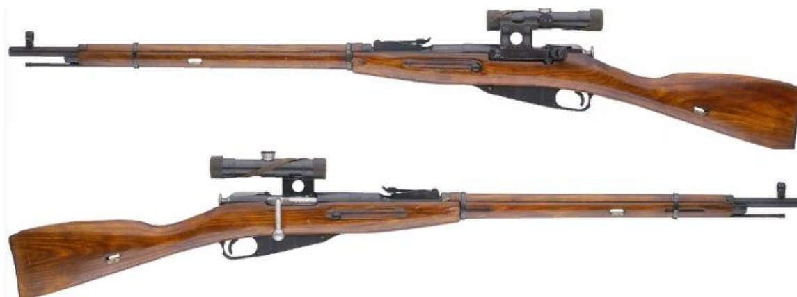
Рис. 7. Снайперская винтовка СВМ-91/30 с оптическим прицелом ПУ
