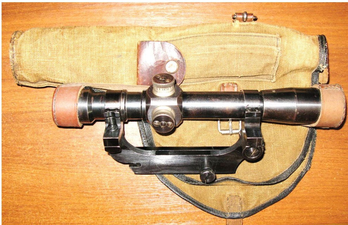
Рис. 5. Внешний вид прицела ПЕ обр. 1937 г. с кронштейном бокового крепления, чехлом и пылезащитными колпачками
