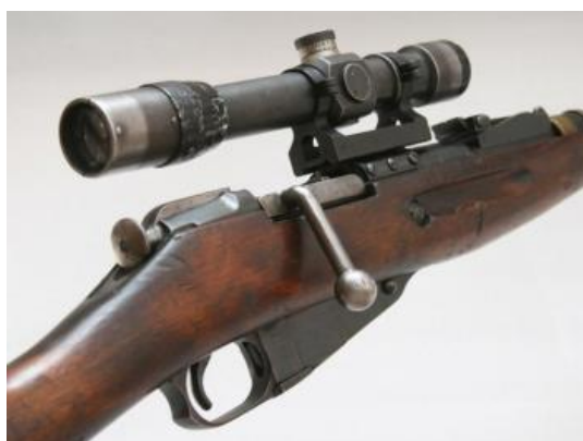
Рис. 3. Снайперская винтовка СВМ-91/30 с оптическим прицелом ПЕ
